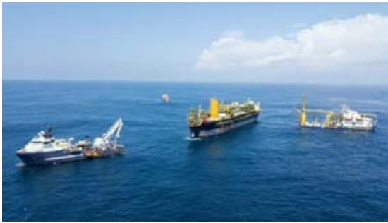
Kuva Norsunluurannikolta jossa ankkuroitiin paikalleen FPSO-alus (Floating Production Storage and Offloading) sekä avustettiin alusta kytkemään tuotantolinjat.
