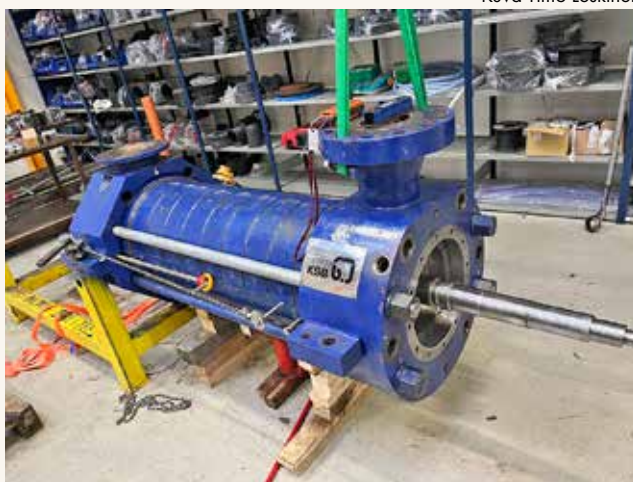
Syöttövesipumppu KSB HGC 5/10 249 bar 100 l/s. Pumpun jaksojen määrä 10 ja hydraulikan koko 5.
