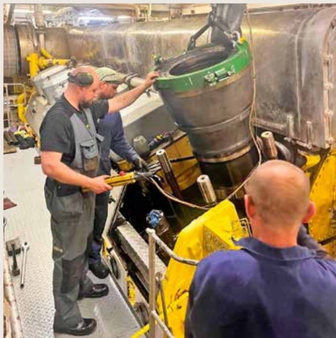
Kuvassa nostetaan lineria eli sylinteriputkea ylös koneesta. Sitä ennen on nostettu pois tieltä sylinterikansi sekä mäntä, minkä jälkeen vasta on voitu sylinteriputki nostaa ylös. Kraanaa käyttää konepäällikkö Toni Koivisto. Konemestarit Anton Märtensson ja Gennadi Kohan mukana hommassa.
