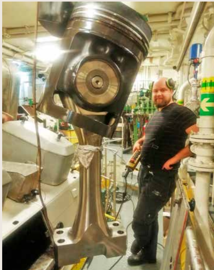
Konepäällikkö Toni Koivisto on juuri nostanut männän ylös M/S Mistralin koneesta. Kiertokankeen sidottu rätti estää öljyä valumasta ympäri konehuonetta. Kuvassa näkyvät neljä reikää kierto- kangen alapäässä kuuluvat pinnapulteille, jotka on avattava ennen kuin mäntää pääsee nostamaan.
