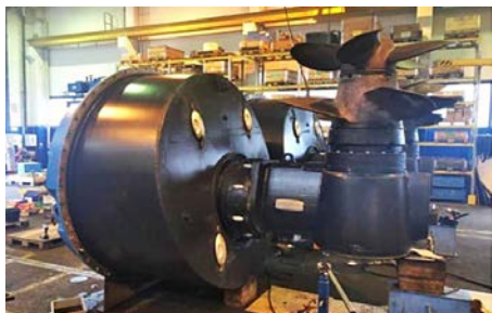
Azimuth-potkurilaitteen peruskorjauksen kuvaaminen 2018.
