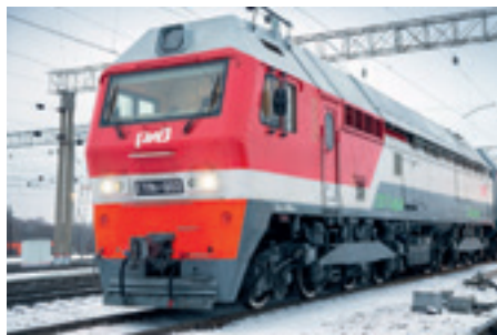
Russian Railways GTh1-002 main gas turbine locomotive (lähde Turbiinitekniikka kirja)
