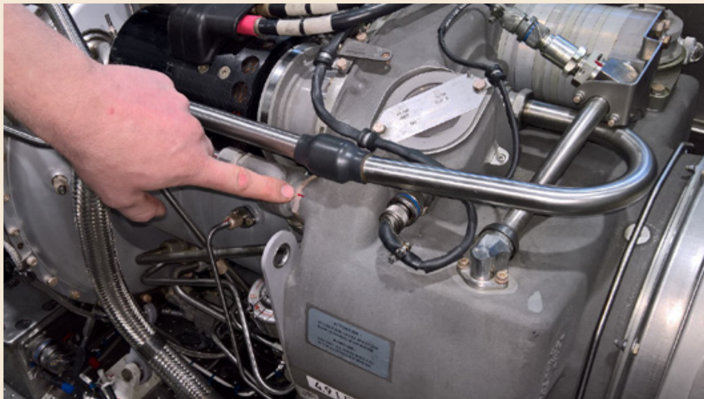
H215 helikopterin moottori, jossa putken kireys on helposti tarkastettavissa maalimerkillä.
