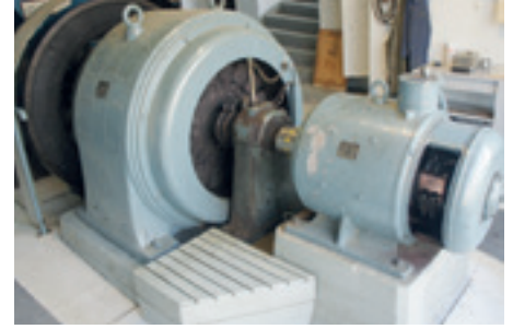
Raskas vauhtipyörä suojalla, 200 kW:n generaattori, laakeripukki ja herätinkoneisto, ja sen sisällä kiiltävä kollettorirengas, johon hiilet hankaavat.
