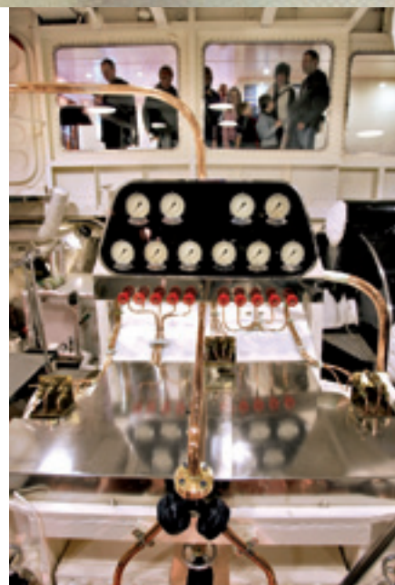
Britannian konehuone ei ole juurikaan muuttunut laivan valmistuttua 1953. ”Automaatio” toimii siten, että joka venttiilin päässä on mies ja varamies.
