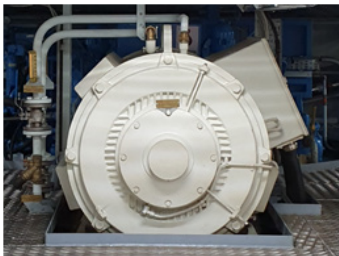
Kuvassa aluksen keulapään propulsiosähkömoottori
