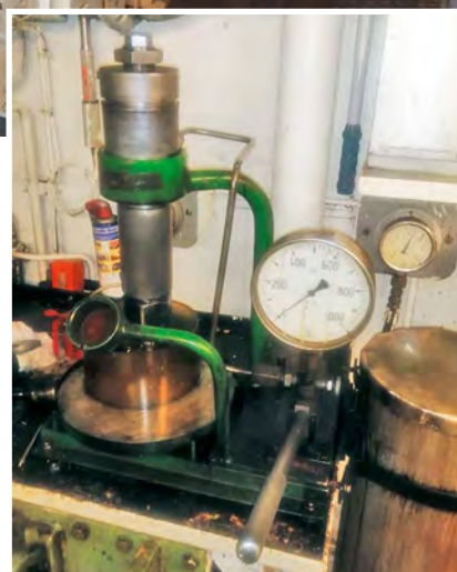
► Provtryckning av bränsleventil till huvudmaskin
