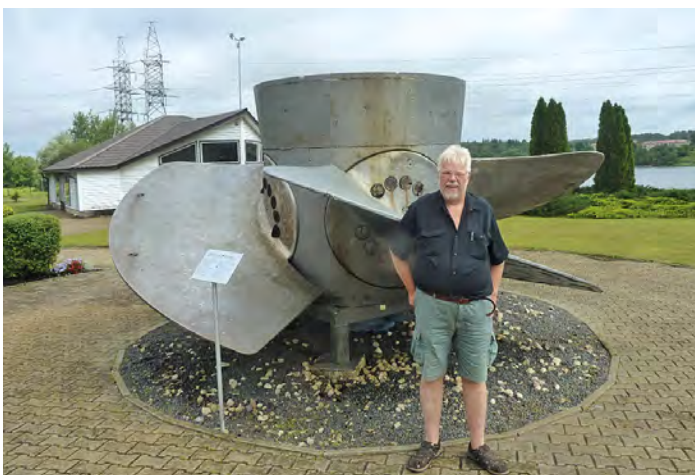
Kaplan (reaktio)vesiturbiinin juoksupyörä.
