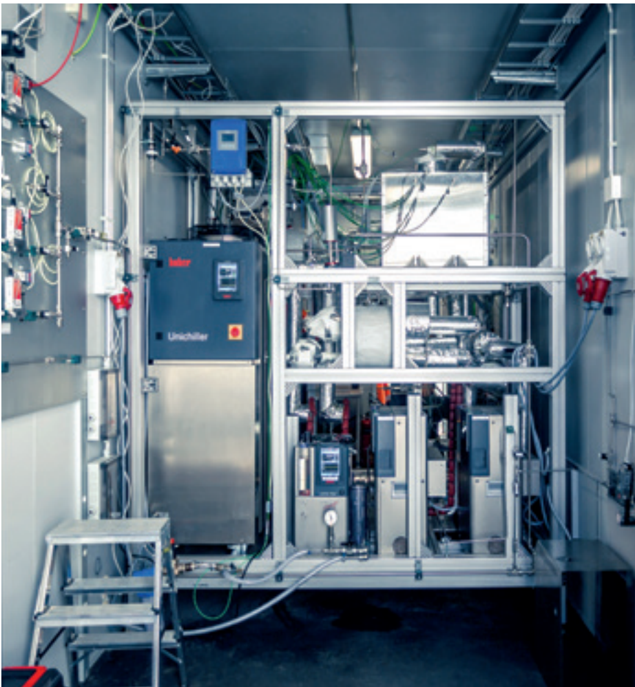
Konttiin on pakattu laitteisto, jossa Fischer-Tropsch menetelmällä hiilidioksidi ja vety reagoivat muodostaen raakaöljyä.
