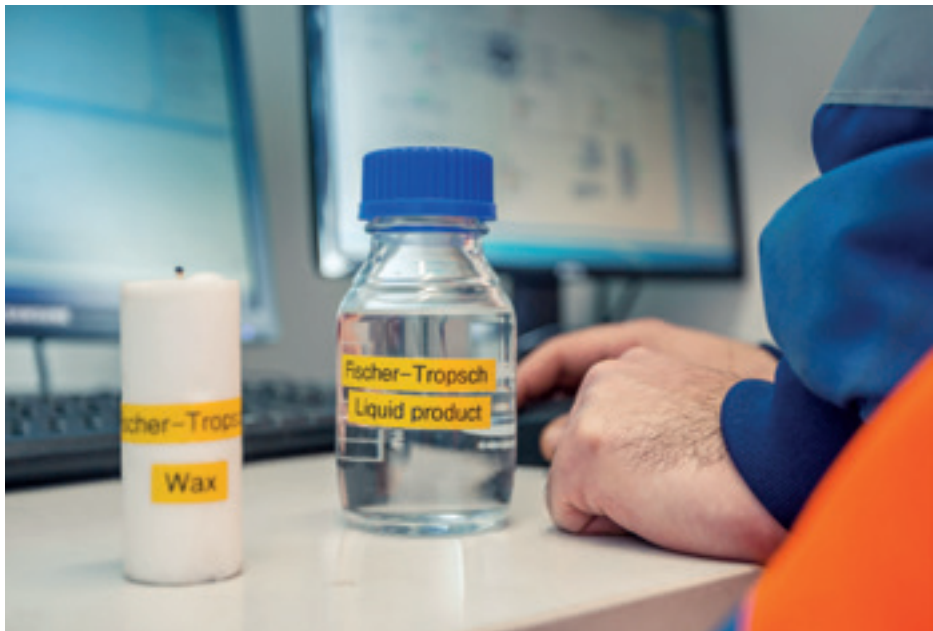
Prosessituotteena saadaan joko vahamaista hiilivety-yhdistettä (oikealla) tai nestemäistä (vasemmalla), joita voidaan jatkojalostaa polttoaineiksi, kemianteollisuuden raaka-aineiksi tai vaikkapa muoviksi.
