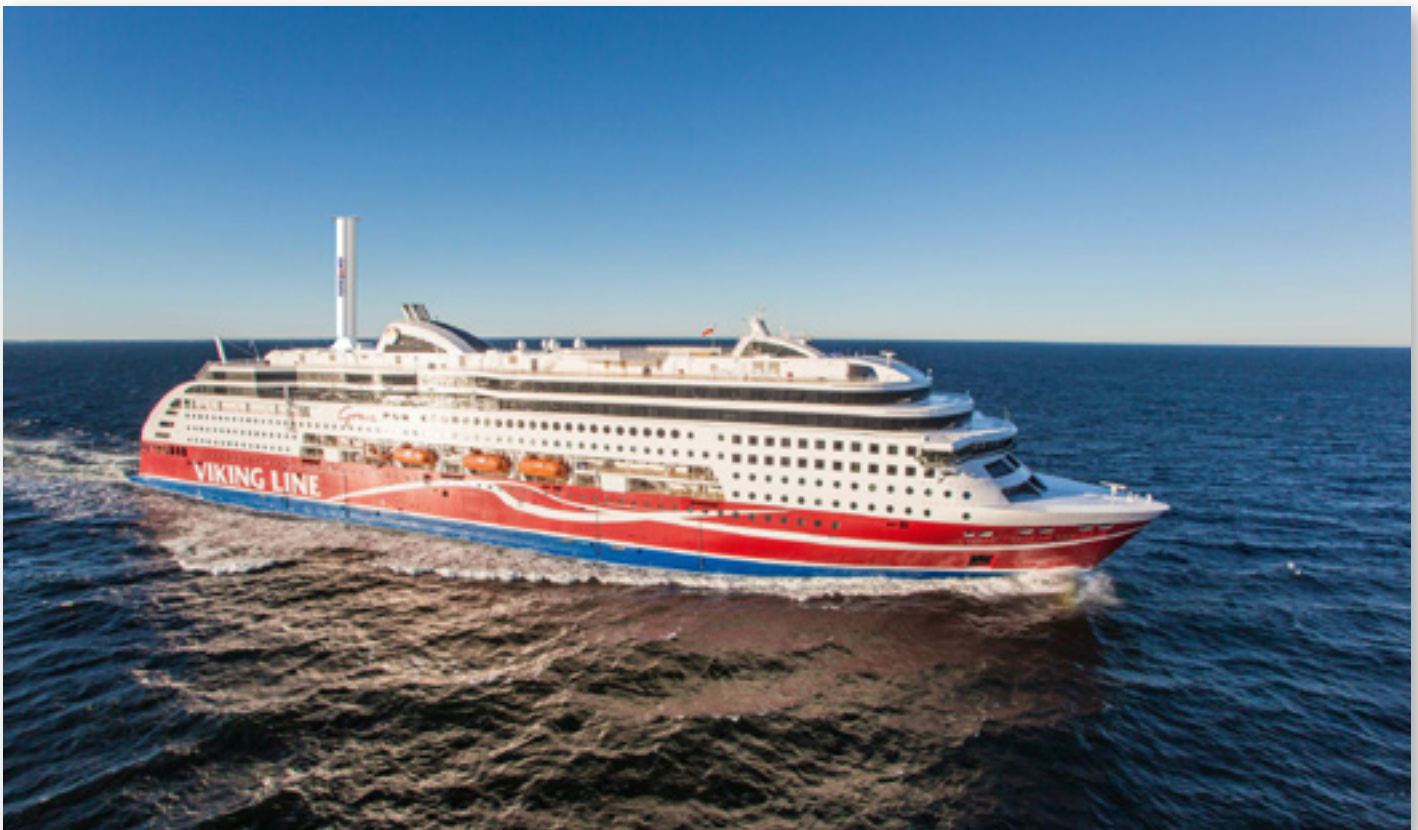
Kuva 3. Viking Gracen havainnekuva roottoripurjeen kanssa. Norsepowerin 24m x 4m roottoripurje asennetaan savupiipun taakse vuoden 2018 keväällä.
